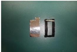
導電性フィルムにマスキングを行い、酸化チタンペーストを塗る
