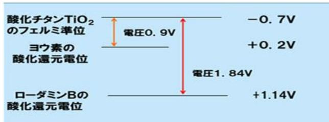
図3 色素増感型太陽電池の発生電位
