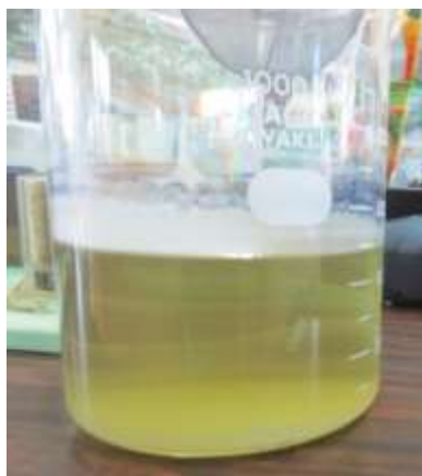
写真 3 ゼリー状の沈殿 (30g の花卉を使用した結果)
