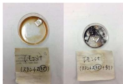
図4 10日後のレモン汁+日光でのステンレス板の様子
