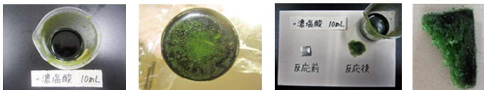
図1 7日後の塩酸 12mol/L の腐食の様子
