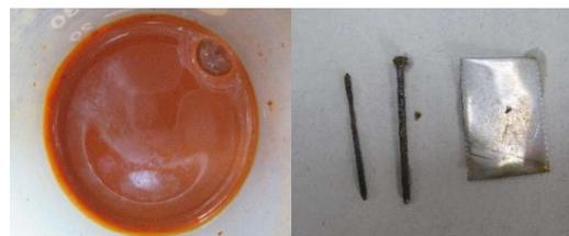
図3 7日後の塩酸+鉄釘の溶液の様子
