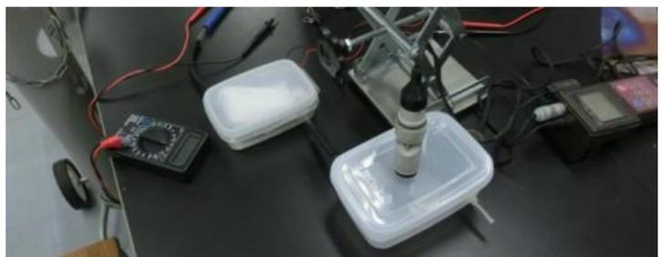
写真6:プラスチック中をアルゴンガスで置換
