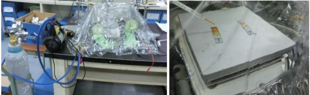
写真2:アルゴンガス中でのホットプレートによる加熱処理
