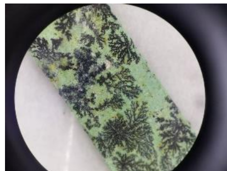
Fig. 3 銅めっき後の Mg 金属表面 (倍率 20 倍)
